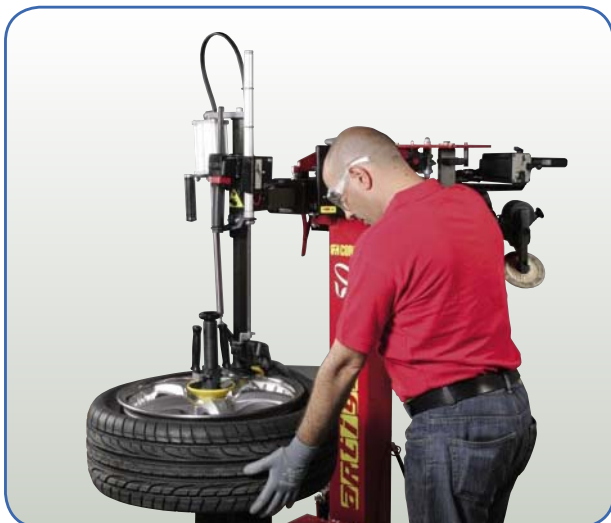
» Procedura di smontaggio del tallone superiore Ülemise rehvipoole demonteerimine.
