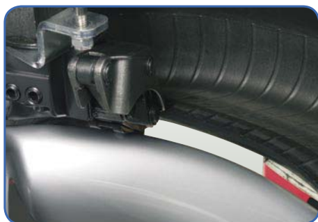
» Procedura standard di smontaggio del tallone inferiore con torretta Alumise rehvipoole standardne eemaldamine montaaži-/demontaaži pe abil.
