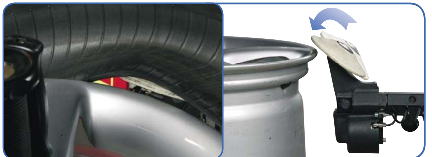
» Procedura rapida con disco stallonatore (particolarmente indicata con fianchi duri) per lo smontaggio del tallone inferiore Alumise rehvipoole kiire demonteerimine rehvi serva lahtisurumise ketta abil (eriti hea kasutada jäikade rehvikülgede puhul).
